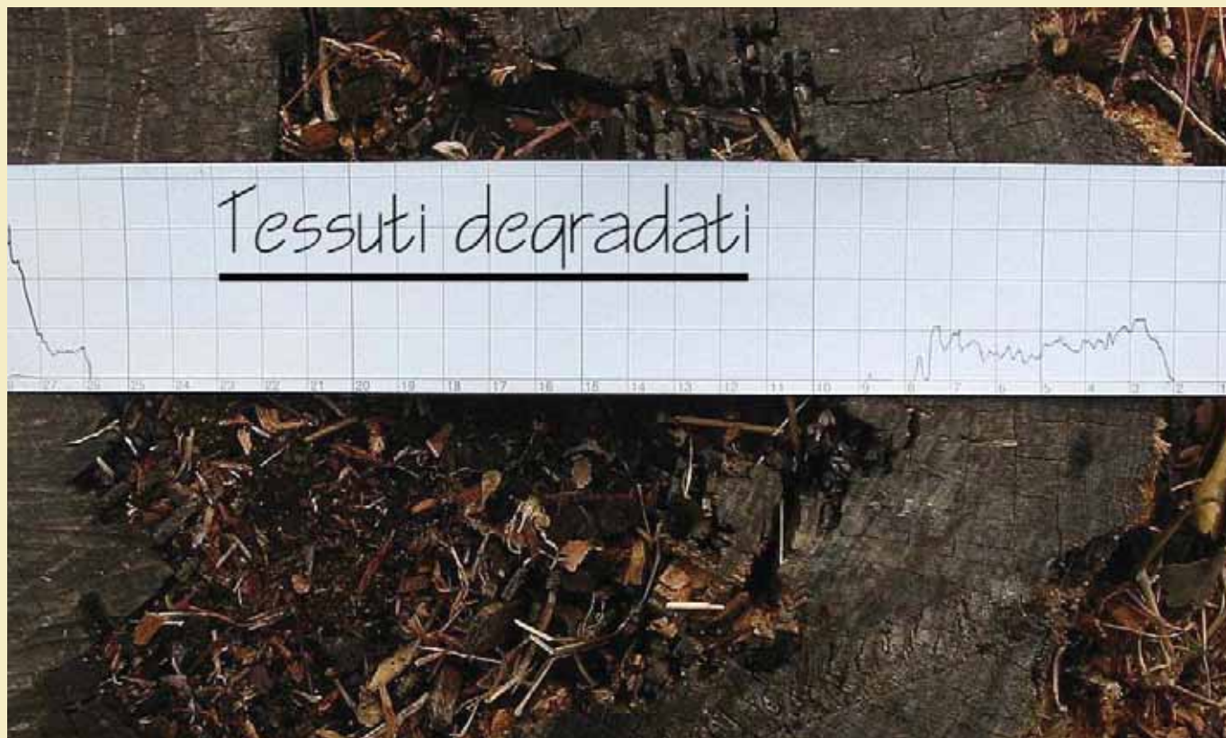
Sezione di un tronco di Pino domestico con una vistosa degradazione: il grafico sovrapposto mostra, infatti, l'estesa carie nella porzione centrale
